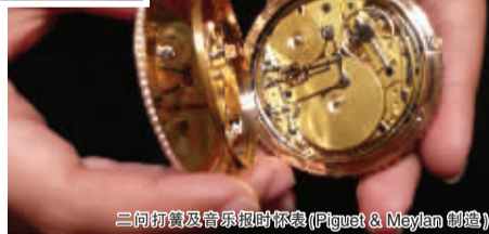
二问打簧及音乐报时怀表(Piguet & Meylan 制造)
